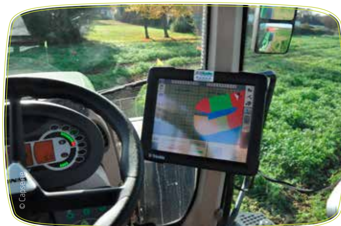
L'informatique embarquée permet d'ajuster les doses d'engrais au plus près des besoins de la plante.
