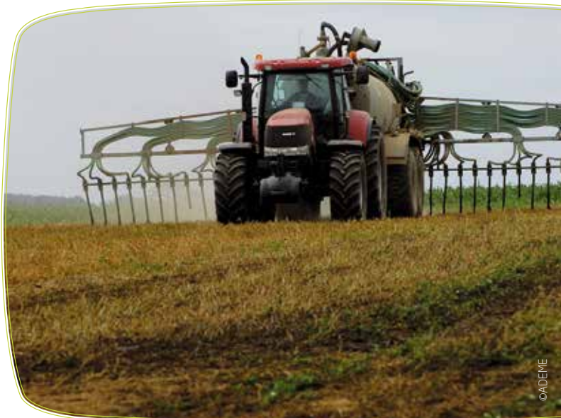
L'utilisation de pendillards permet d'apporter des effluents sous couvert tout en limitant la volatilisation de l'ammoniac.
